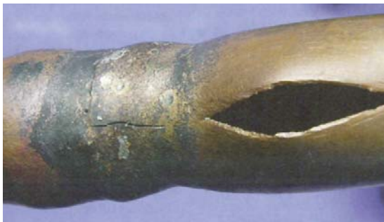
Účinky mrazu na natvrdo spájenou měděnou trubku
